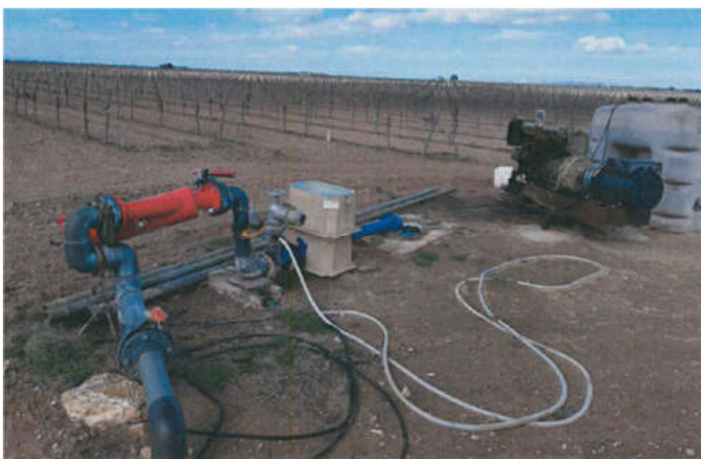
Figura 3.7. Incorrecto. Contador en arqueta cerrada. Motor, depósito de gasóleo y demás elementos a la intemperie.
